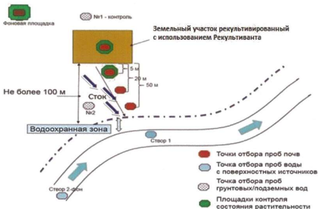
Рисунок 2 – Схема размещения пробных площадок для контроля природных сред, прилегающих к рекультивированному земельному участку
