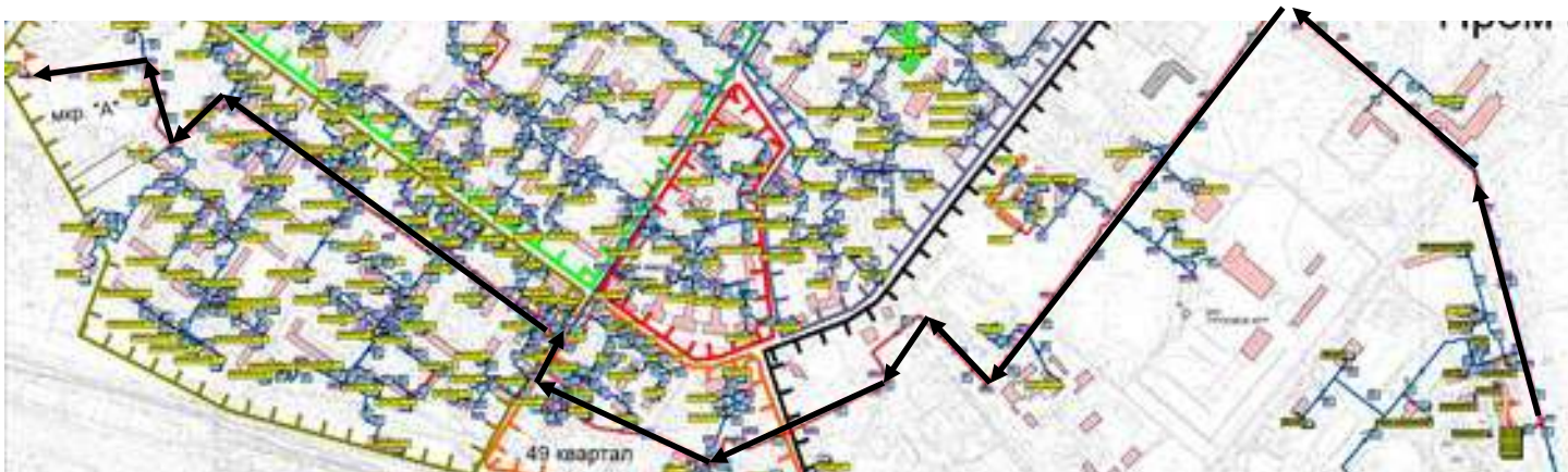
Рис.3.9.. Путь движения теплоносителя от котельной до здания ул. Николаева д.10
