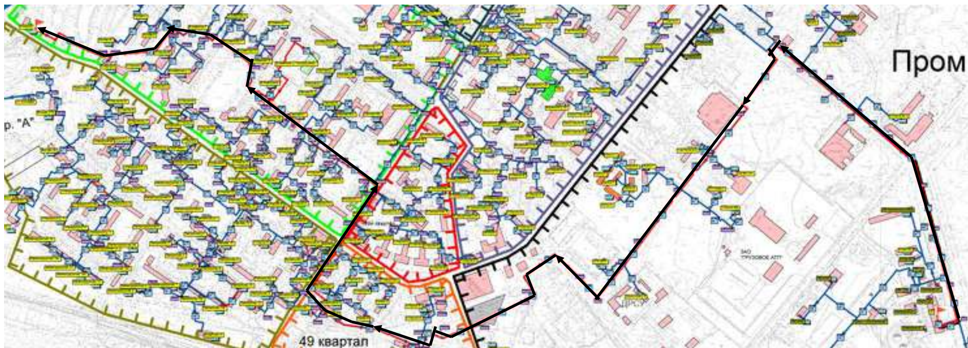
Рис.3.5. Путь движения теплоносителя от котельной до здания ул. К. Маркса, д.1 (мкр.Б)
