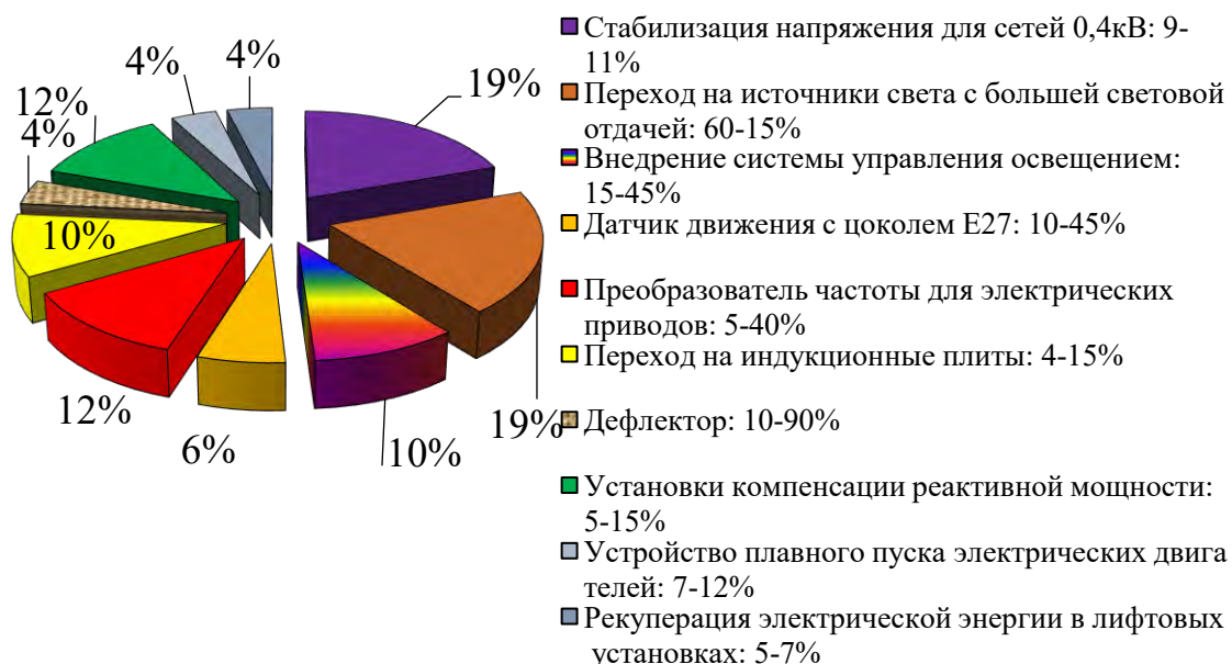
Рисунок 4.10 – Состав и вклад технологий, приводящих к экономии электрической энергии
