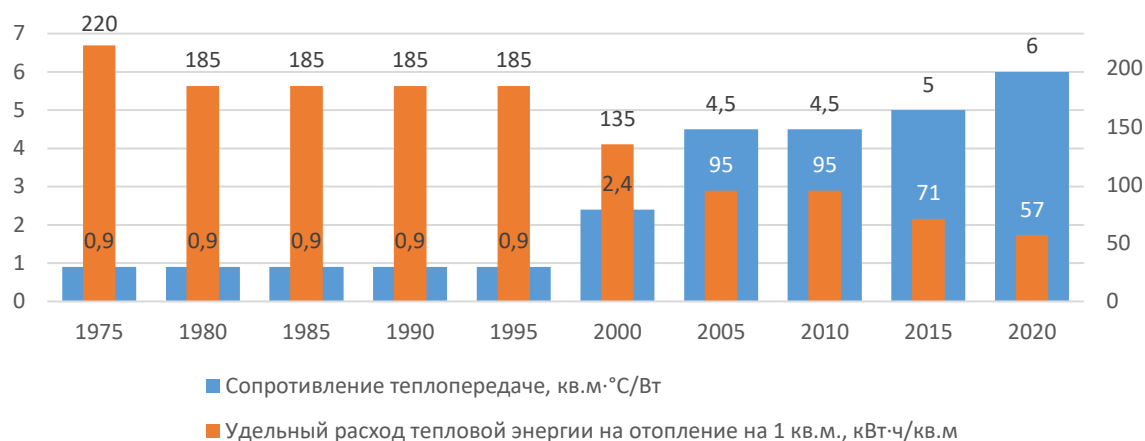
Рисунок 4.8 – Динамика изменения нормативных значений сопротивления теплопередаче и удельного расхода тепловой энергии на отопление для г. Москвы
