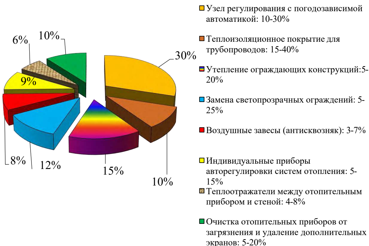
Рисунок 4.9 – Состав и вклад технологий, приводящих к экономии тепловой энергии
